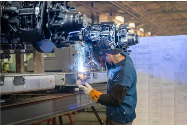
**Verschiedene Bauteile werden zu einem Fahrgestell verschweisst.**
