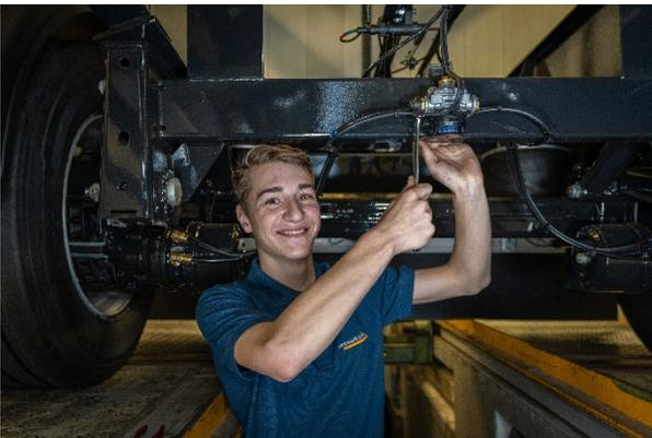
**Pneumatik- und Elektro-komponenten werden mit viel Handarbeit am Fahrzeug verbaut**
