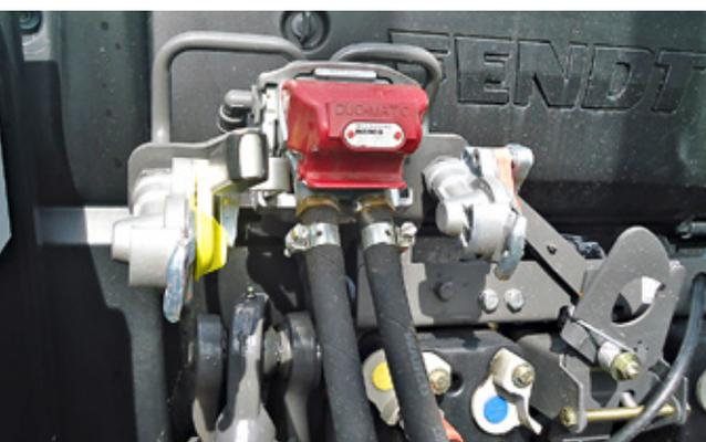
Das System «Duomatik» erleichtert das Ankuppeln der Druckluft-Bremsanschlüsse
