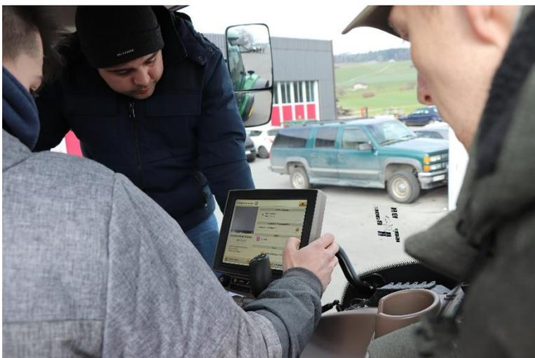
*Praktisch mit Lenksystemen arbeiten am BBZN Hohenrain: Die Teilnehmer müssen zuerst die Maschineneinstellungen hinterlegen, dann Fahrspuren anlegen und am Schluss mit dem Traktor auf der Parzelle aktiv fahren.*
