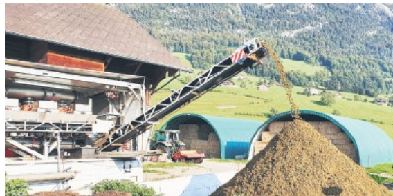
Ein mobiler Separator im Einsatz. Durch die Trennung können die Nährstoffe gezielter und bedarfsgerecht eingesetzt werden. (Foto: Markus Bucheli)
