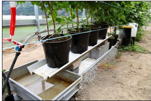
Auffangschale zur Drainwassermessung von drei Töpfen
