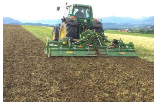
Die 6m breite Cellifräse hobelt die Wiese ab.
