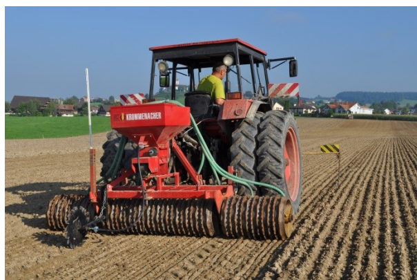
Bild 1: Kombisaat, hier Mulchsaatverfahren
