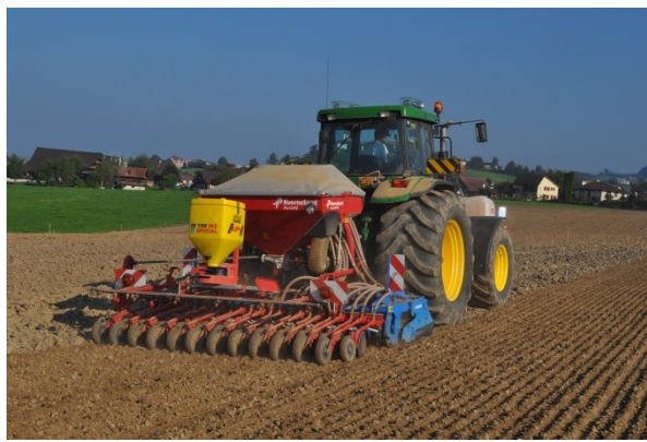
Bild 2: Solo-Saat der Untersaat mit Krummenachersäegerät
