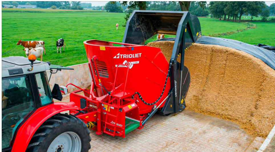
«Bei einem gemeinschaftlichen Fahrtilo kann es sinnvoll sein, in einen gemeinsamen Futtermischwagen – der etwa mit einer Entnahmefräse ausgestattet ist – zu investieren», sagt Thomas Haas. (Bild: zvj)
