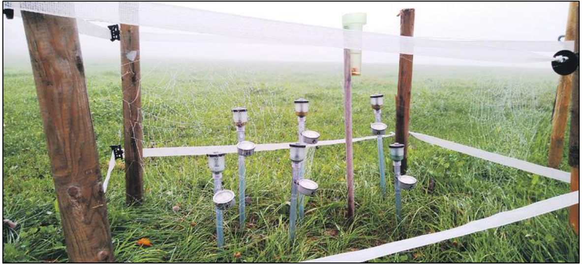
Abbildung 3: Tensiometerstation in Hohenrain. Damit wird die Bodenfeuchtigkeit gemessen, was Hinweise über den Bodenzustand und damit für die Bewirtschaftung liefert. (Bild Felix Etterlin)
