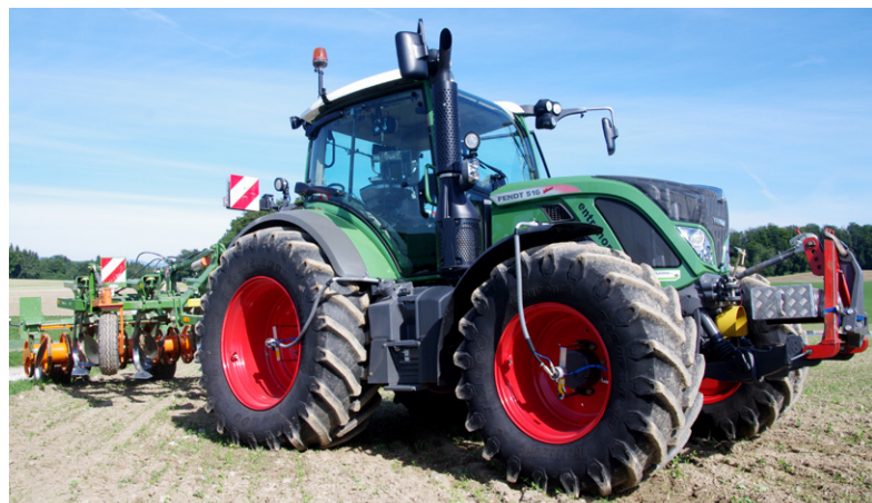
[Bild 7] Reifendruckverstellanlagen sowie Arbeitsgeräte mit eigenem Fahrwerk ermöglichen eine optimale Verteilung des eingesetzten Maschinengewichts auf der Bodenoberfläche.
